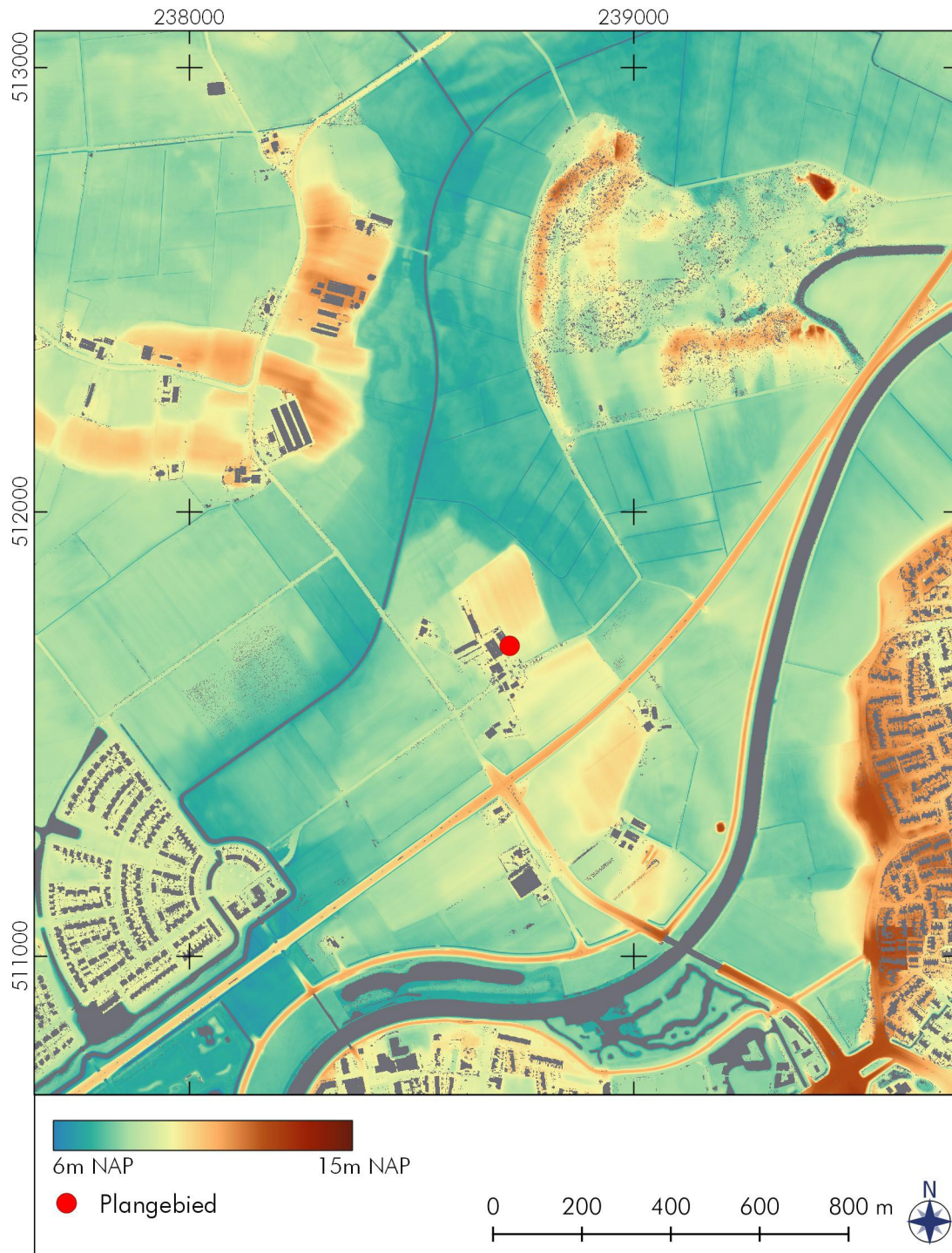
Figuur 5: Collendoorn, Hofsteeweg 2: hoogtekartaart van de omgeving van het plangebied. De hogere dekzandruggen (geel/oranje) zijn duidelijk zichtbaar in het landschap. Ook is te zien dat er grote delen van de oorspronkelijke dekzandruggen als gevolg van de verkaveling zijn geëgaliseerd of verlaagd (te zien aan de scherpe overgangen tussen hogere en lagere delen langs de kavel grenzen). Ten noorden van het plangebied is nog een oude loop van de rivier in de lagere delen zichtbaar. Bron: Actueel Hoogtebestand Nederland 2 (AHN2).
