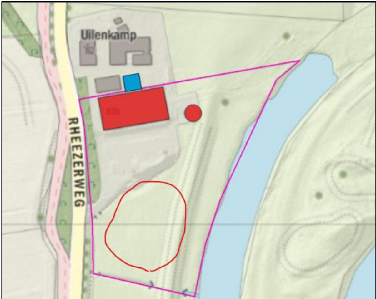
Figuur 3. Te slopen objecten, rode elementen worden gesloopt of verwijderd, blauwe element blijft behouden. Bron: Eelerwoude, 2019
