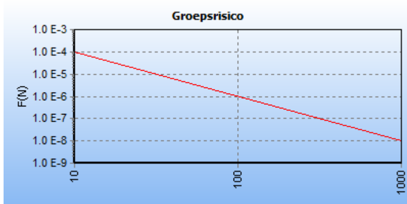
5.5 Figuur 5.5 FN curve voor 7276_leiding-N-527-48-deel-1 van N.V. Nederlandse Gasunie voor de kilometer tussen stationing 0.00 en stationing 870.00
