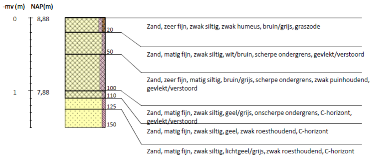
Boring 8 RD-coördinaten: 238589/510152 - Edelmanboor \varnothing 7 cm
