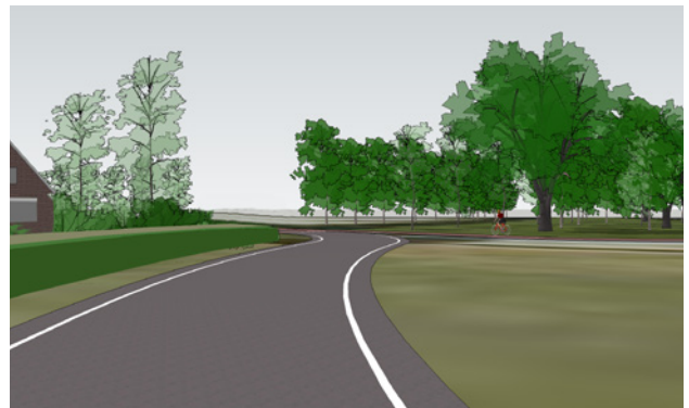
6. Nadering entree Boshoeck: goed zicht op fietspad rechts, de haag schermt lichthinder van koplampen richting Hessenweg af
