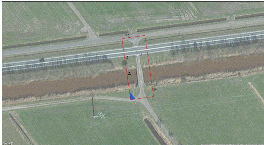
Afb.28. – Situatie 2013 met duidelijk zichtbaar het Ommerkanaal, de N377 en de voormalige watergang (blauw gearceerd)
