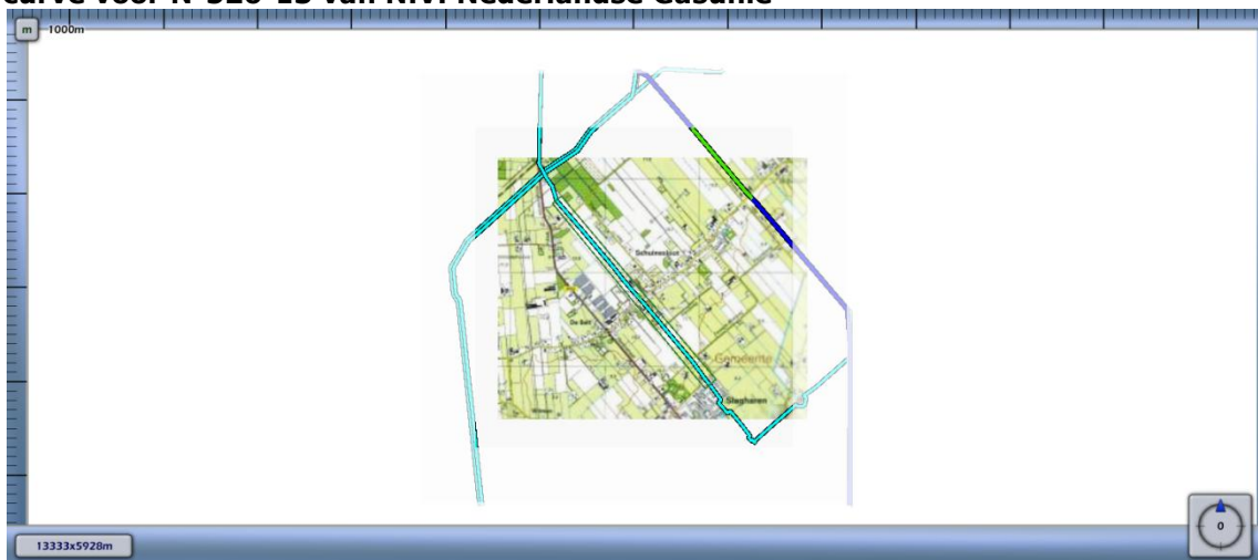
Figuur 4.8 Kilometer leiding behorende bij de maximale overschrijding van de FN-curve voor N-526-13 van N.V. Nederlandse Gasunie
