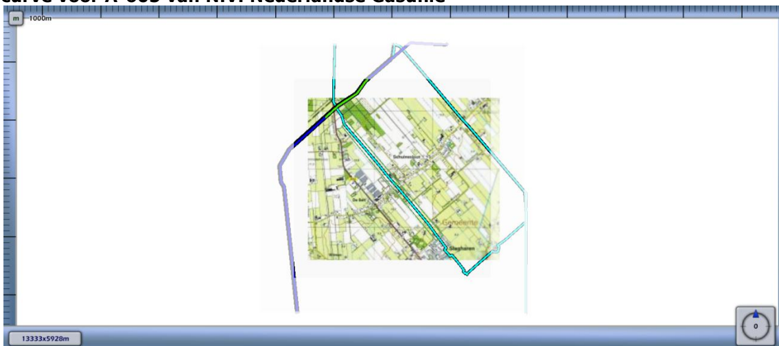
Figuur 4.4 Kilometer leiding behorende bij de maximale overschrijding van de FN-curve voor A-605 van N.V. Nederlandse Gasunie
