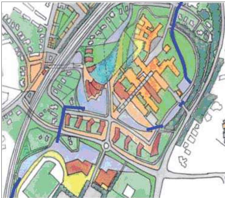
Koppeling met bestaande waterstructuur
