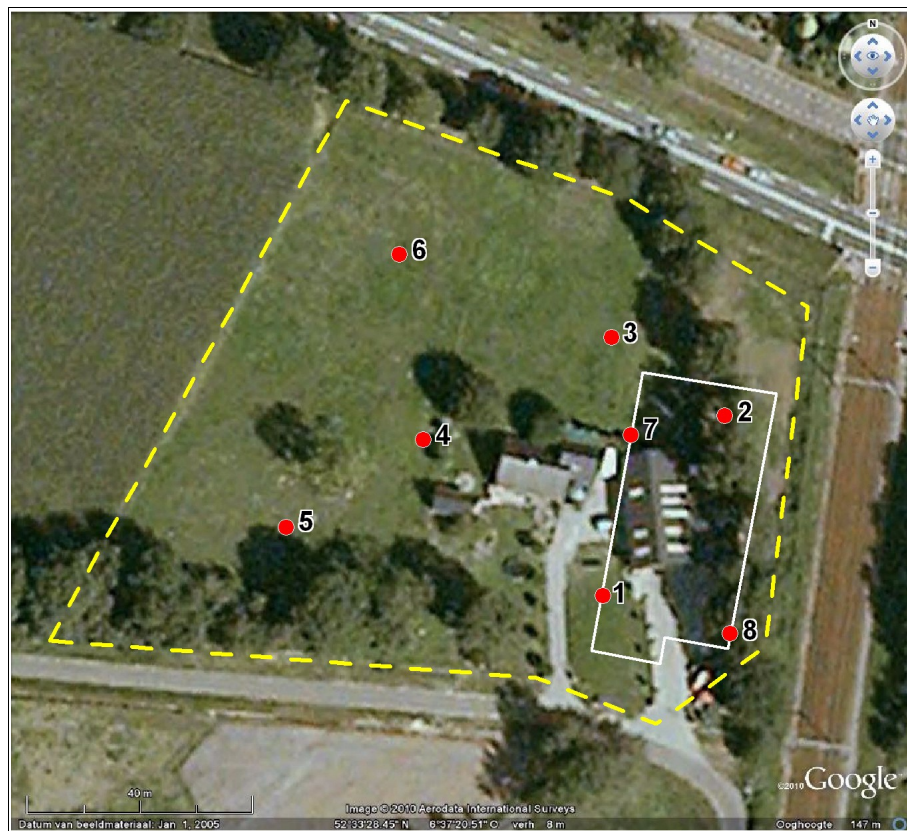
Figuur 6: Brucht, Spokenkampweg 2: boorpuntenkaart. Het onderzoeksgebied wordt aangegeven door de onderbroken gele lijn, de locatie van de geplande loods door de witte lijn. De genummerde acht rode punten zijn de boorlocaties.
