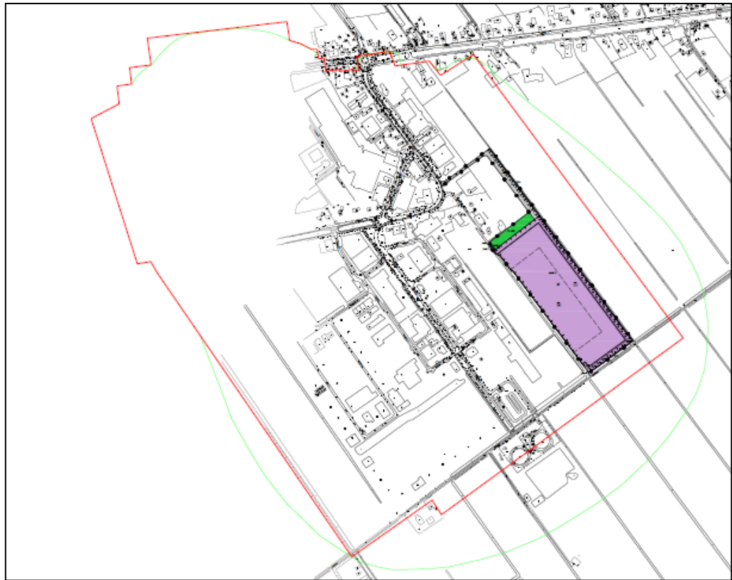
Figuur 13. Voorstel nieuwe geluidscontour, afgeleid uit het akoestisch onderzoek industrielawaai. Paarse vlek is globale begrenzing plangebied. Rode lijn is de huidige geluidscontour. De groene lijn is de nieuwe geluidscontour.
