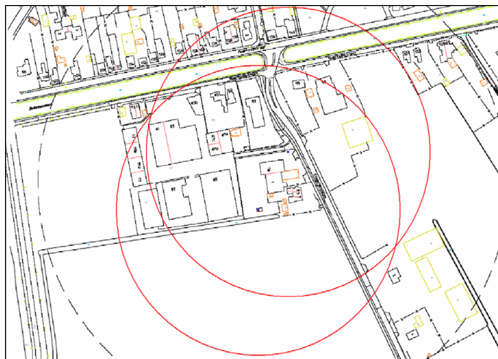
Figuur 2.1b Omgeving van het LPG-tankstation en invloedscirkels (rood: 150 m) rondom het vulpunt en de ondergrondse tank
