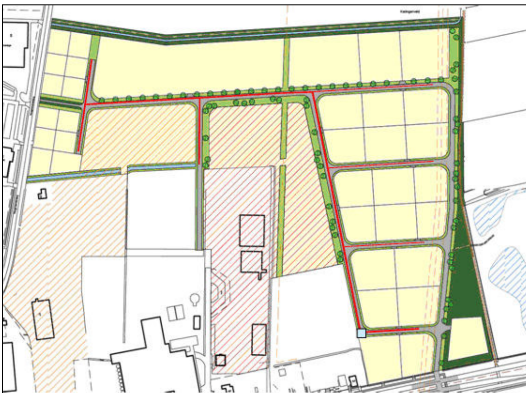
Figuur 8 Hoofdstructuur riolering
