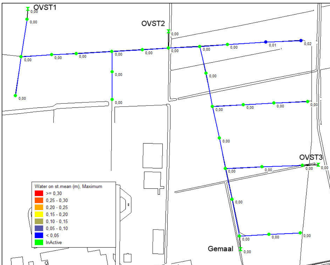
Figuur 14 water op straat bui09
