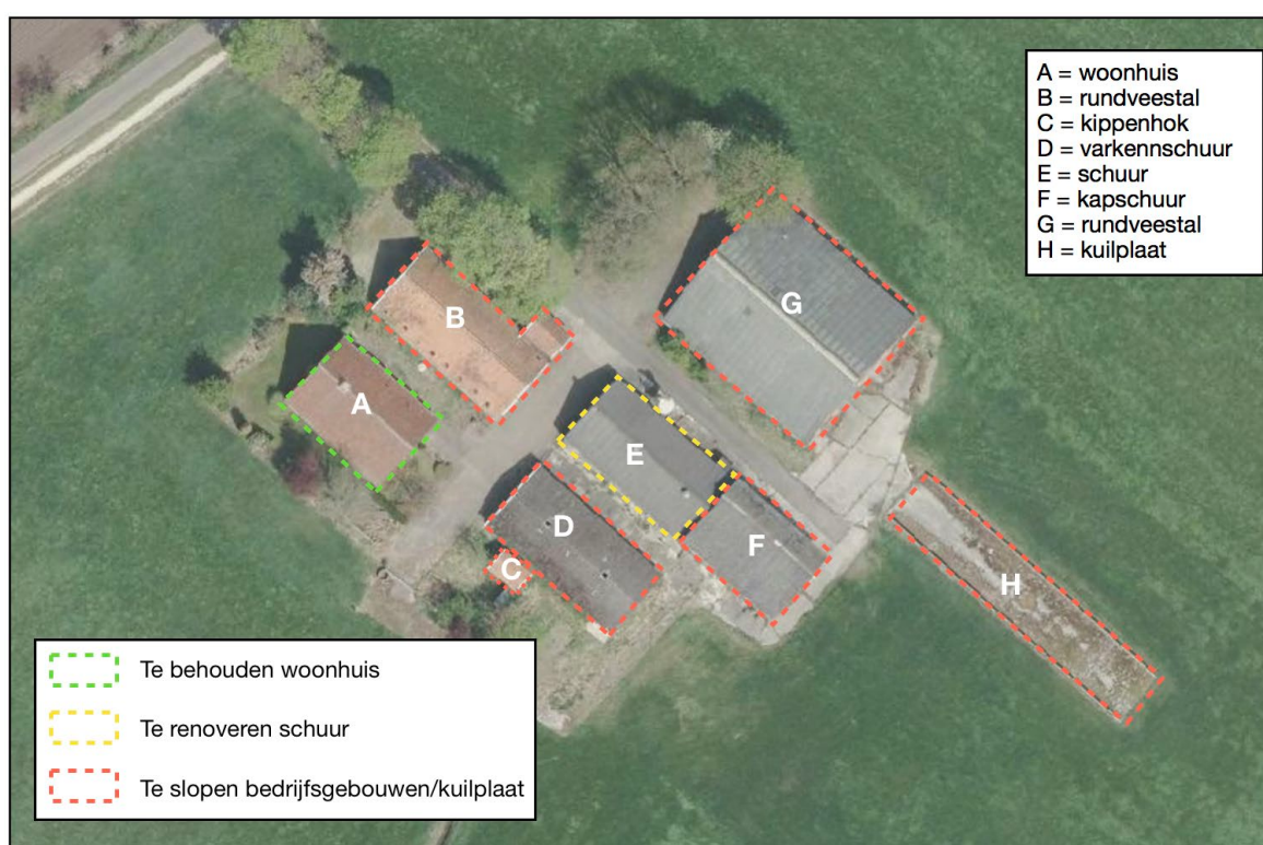
Afbeelding 2.1 Te slopen, te behouden en te renoveren bebouwing locatie Knoefweg 16 (Bron: Atlas van Overijssel, bewerkt)
