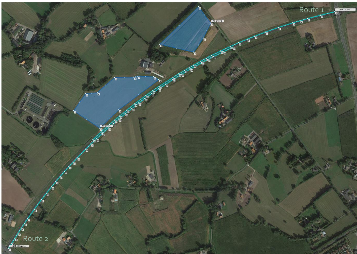
Figuur 4.1: Ingetekende zonnepark (transparant blauwe vlak) met daarbij de twee routes waarvoor de reflectie berekend wordt.
