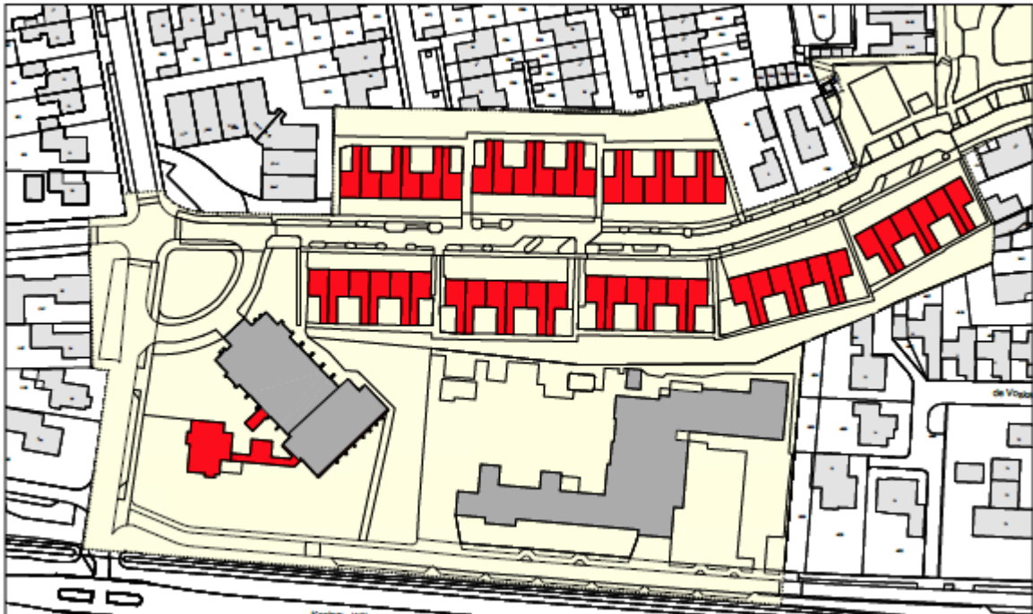
Afbeelding 3.1 Sloopopgave (Bron: L&O Architecten)
