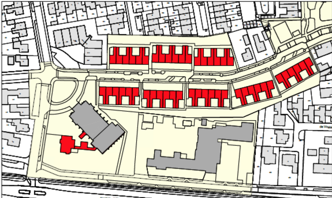
Afbeelding 3.1 Sloopopgave (Bron: L&O Architecten)
