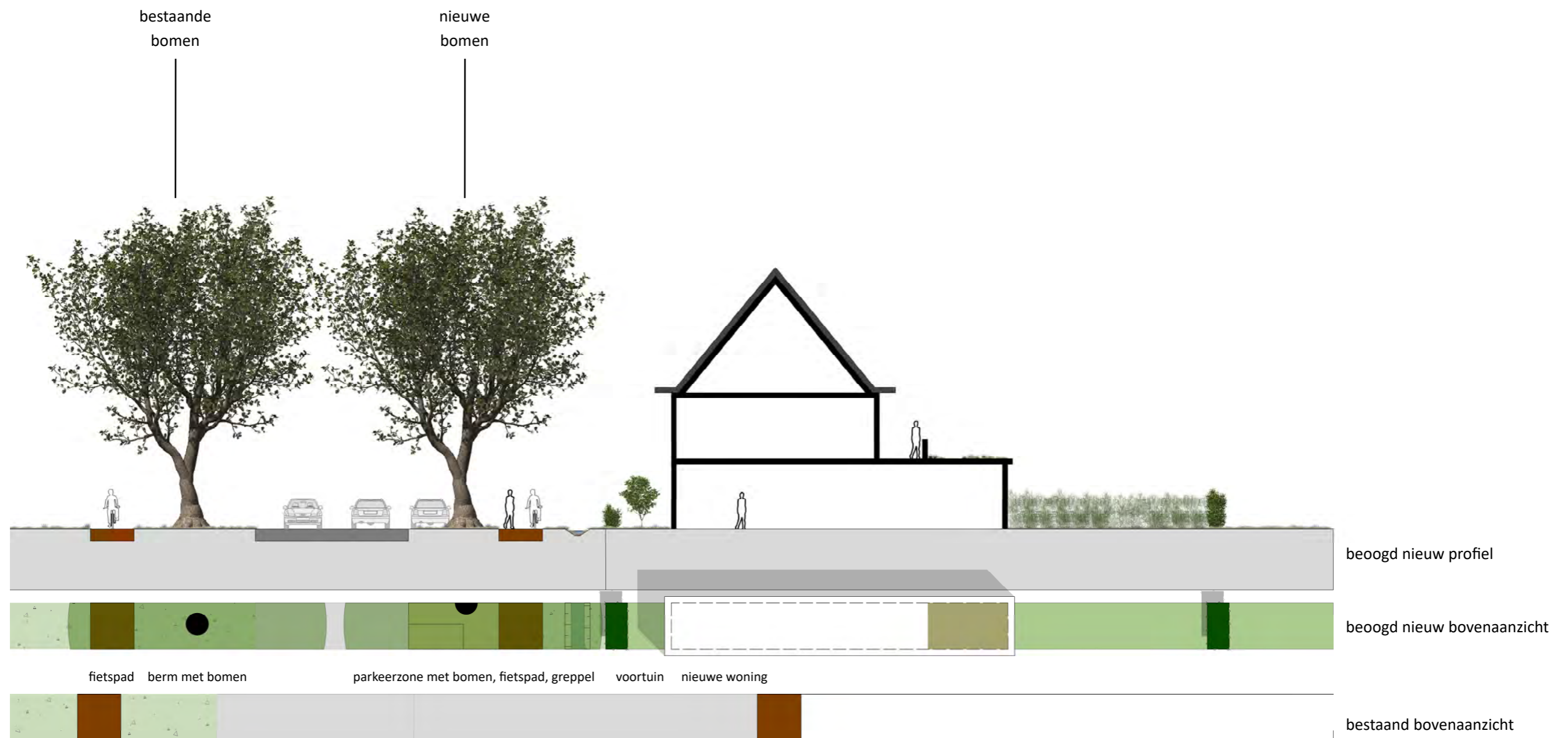
Afbeelding 49. Doorsnede (E) met uitstraling Enschedesestraat met parkeerzone in de berm voor nieuwe woningen.
