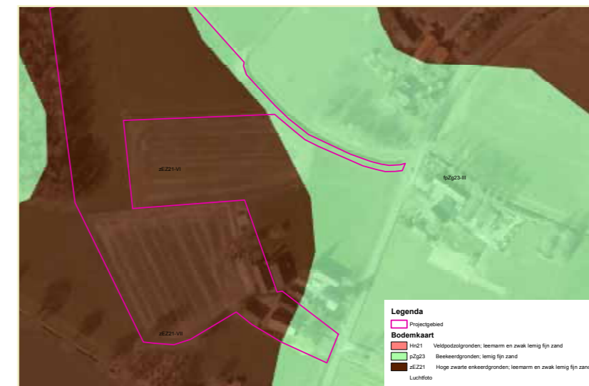
Afbeelding: Bodemtype aanwezig in het projectgebied: de voortuin ligt op de bekeerdgrond. De schuren staan op de hoge zwarte enkeleerdgrond.
