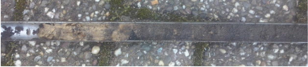
Figuur 3: Foto van de vergraven toplaag met daaronder de vergraven top van de C-horizont zoals deze op boorpunt 3 is aangetroffen.
