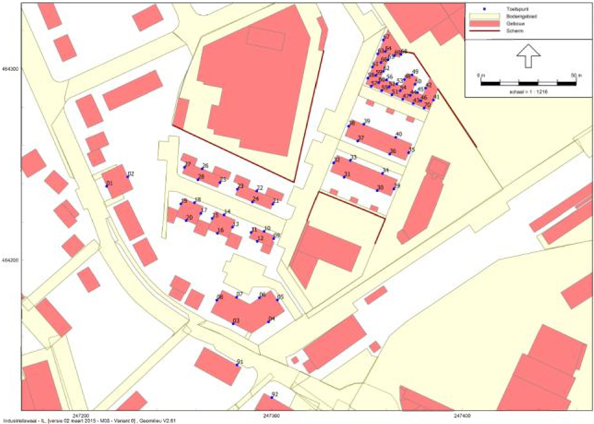
Akoestisch rekenmodel met ligging beoordelingspunten Punten 91 en 92 worden gebruikt voor toetsing brandweergarage
