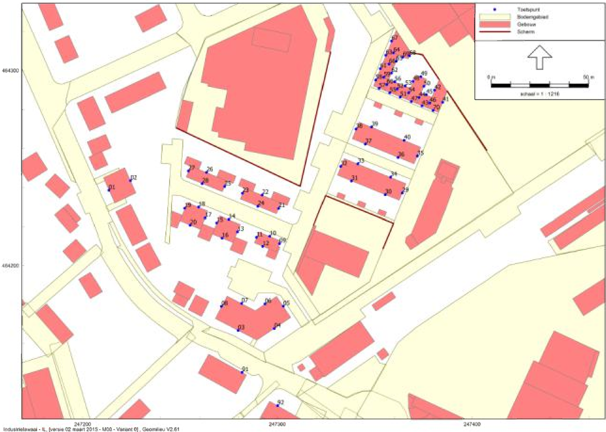
Figuur 1 Akoestisch rekenmodel met ligging beoordelingspunten Punten 91 en 92 worden gebruikt voor toetsing brandweergarage
