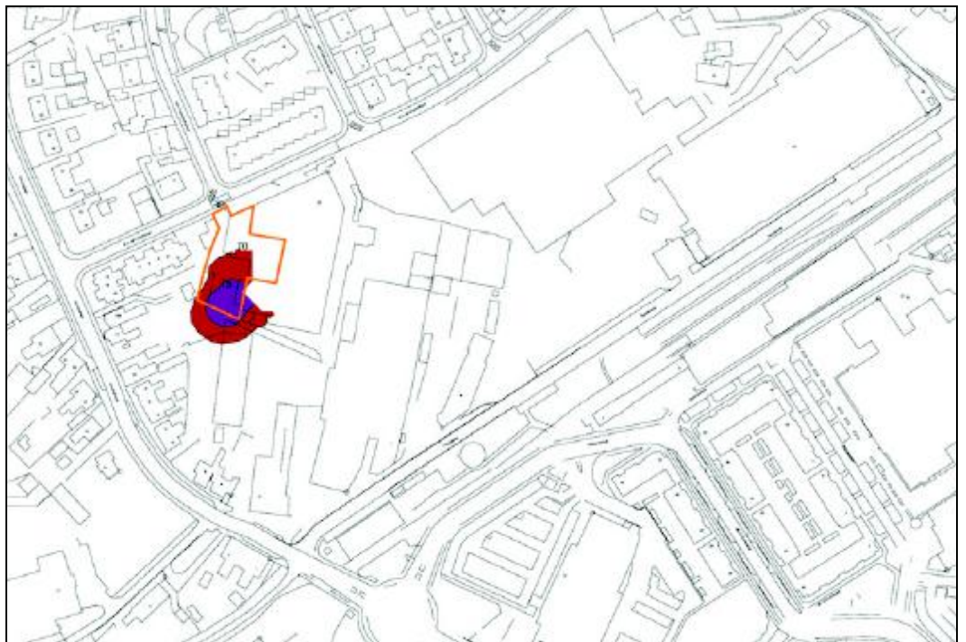
Figuur 6 Contouren maximale geluidsniveaus (etmaalwaarde) op 4,5 meter hoogte
