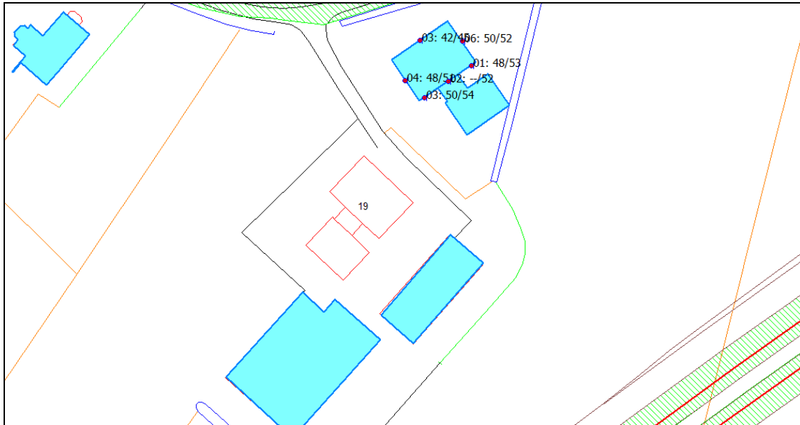
Afbeelding VII: gecumuleerde geluidbelasting ten gevolge van alle wegen, excl. aftrek art. 110g Wgh (toekomstige situatie)
