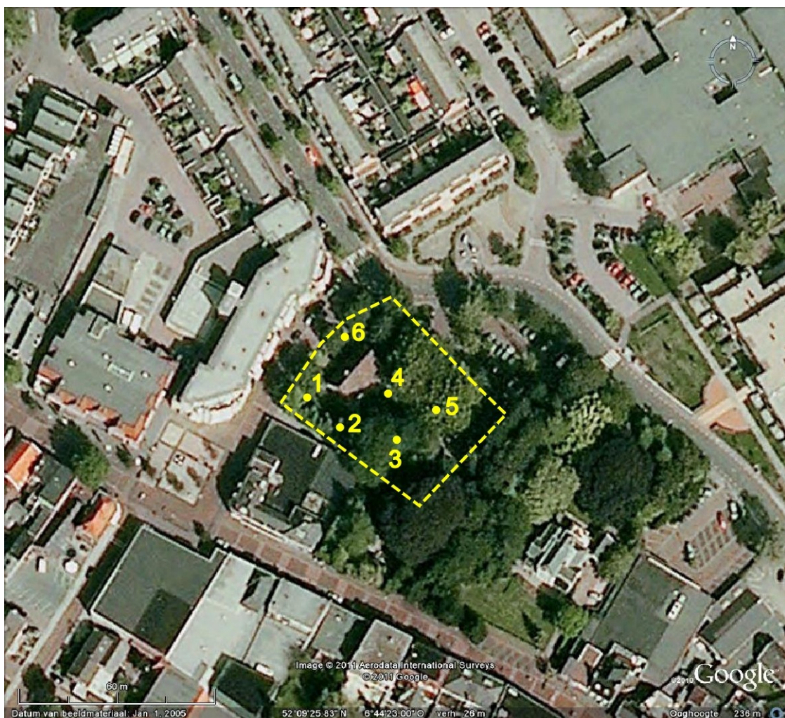
Figuur 5: Haaksbergen, Kalter 2: situatietekening met de boorlocaties. Het plangebied ligt binnen de gele onderbroken lijn. De genummerde cirkels geven de boorlocaties weer. De RD-coördinaten van het onderzochte terrein zijn: N – 247,540/464,105; O – 247,565/464,086; Z – 247,540/464,045; W – 247,515/464,075 [Naar: Google Earth.]
