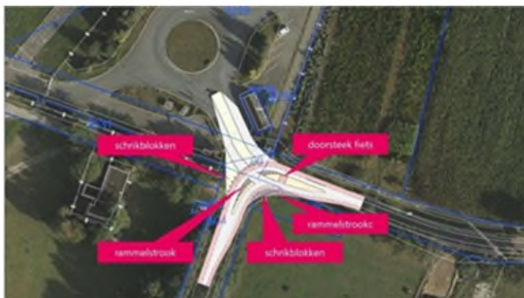
Figuur 6.3 Schetsontwerp aanpassing kruispunt
