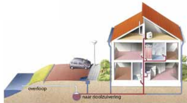
Principe gemengd rioolsysteem
