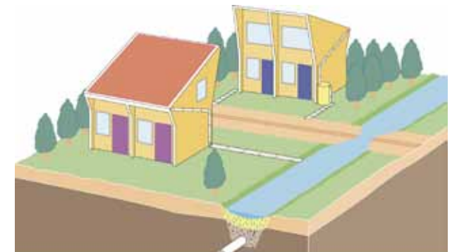
Principe gescheiden rioolsysteem met berging
