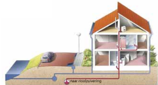
Principe gescheiden rioolsysteem
