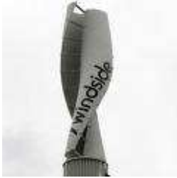
Voorbeelden van verticale as windturbines (v.l.n.r.): Windside; Turby; Ropatec.
