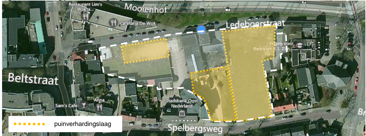
Figuur 10: Situering puinverhardingslagen (bron: 2 en veldinspectie)
