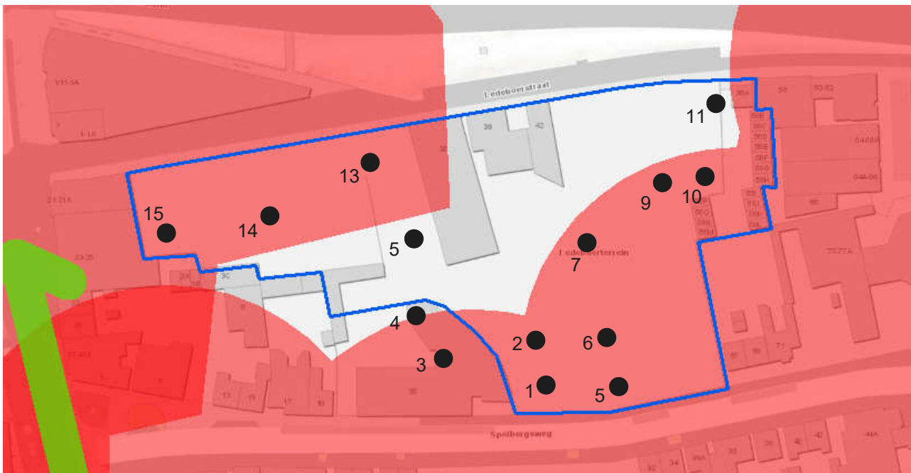
Fig. 19: De locaties van de beschikbare sonderingen (zwarte cirkels) in de verdachte gebieden (rood). De projectlocatie is blauw omlijnd.
