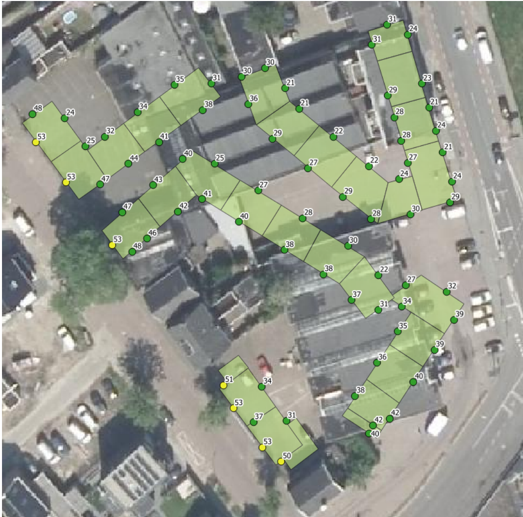
f4.2 Optredende geluidbelasting vanwege de Kottendijk (Lden in dB, inclusief aftrek conform artikel 110g Wgh)
