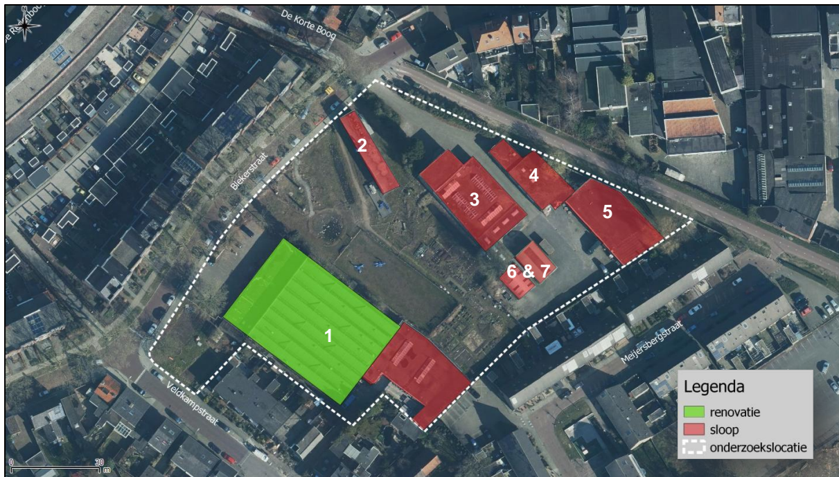
Figuur 2. Luchtfoto onderzoekslocatie en directe omgeving. In de afbeelding is weergegeven welke gebouw gerenoveerd worden en welke gesloopt worden. Ook is de naamgeving per gebouw weergegeven.
