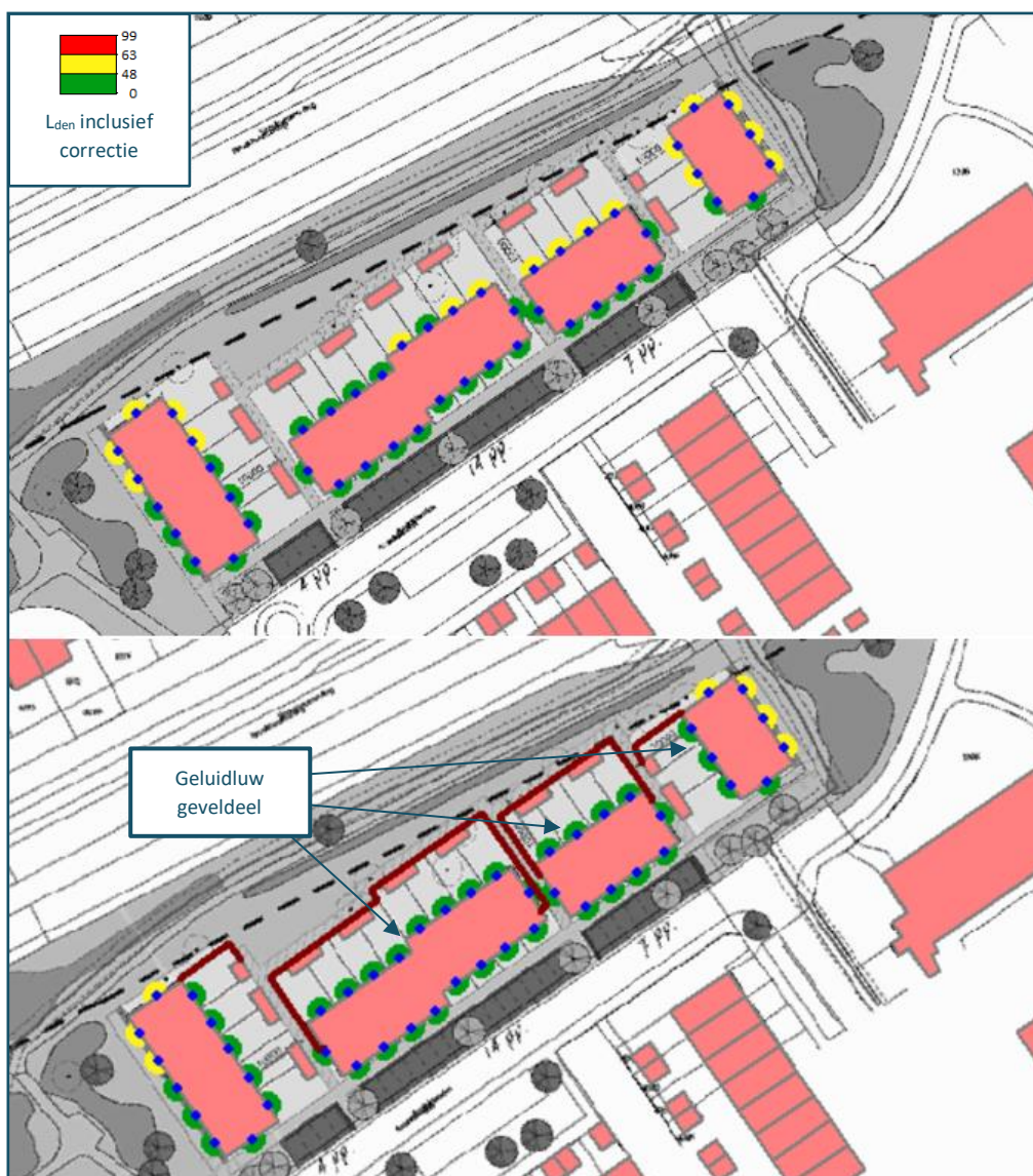
Figuur 8 Weergave van de geluidsbelasting op 1,5 meter hoogte op het oostelijke blok vanwege de Broekheurnering voor het plaatsen van tuinschermen (boven) en na het plaatsen van tuinschermen (onder)
