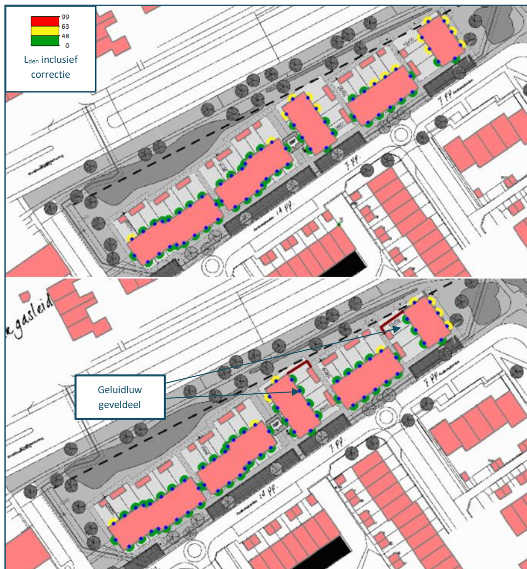
Figuur 7 Weergave van de geluidsbelasting op begane grondniveau op het westelijke blok vanwege de Broekheurnering voor het plaatsen van een tuinscherm (boven) en na het plaatsen van tuinschermen (onder)
