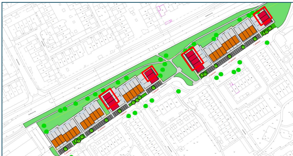
Figuur 5 Weergave van de woningen die niet beschikken over een geluidsluwe gevel
