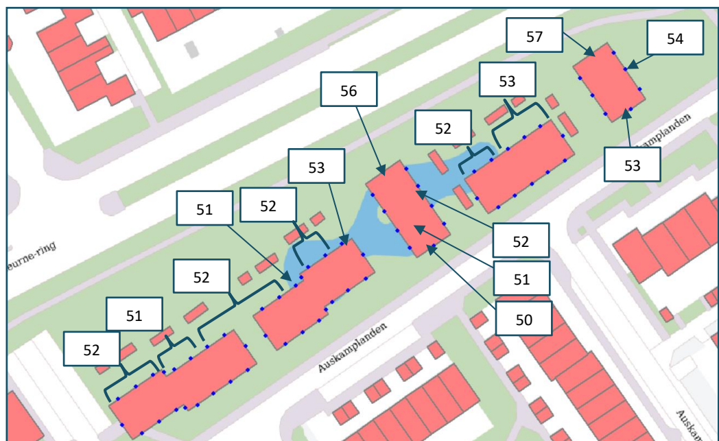
Figuur 13 Benodigde hogere waarde ten gevolge van wegverkeerslawaaï afkomstig van de Broekheurnering per woning voor het westelijk blok
