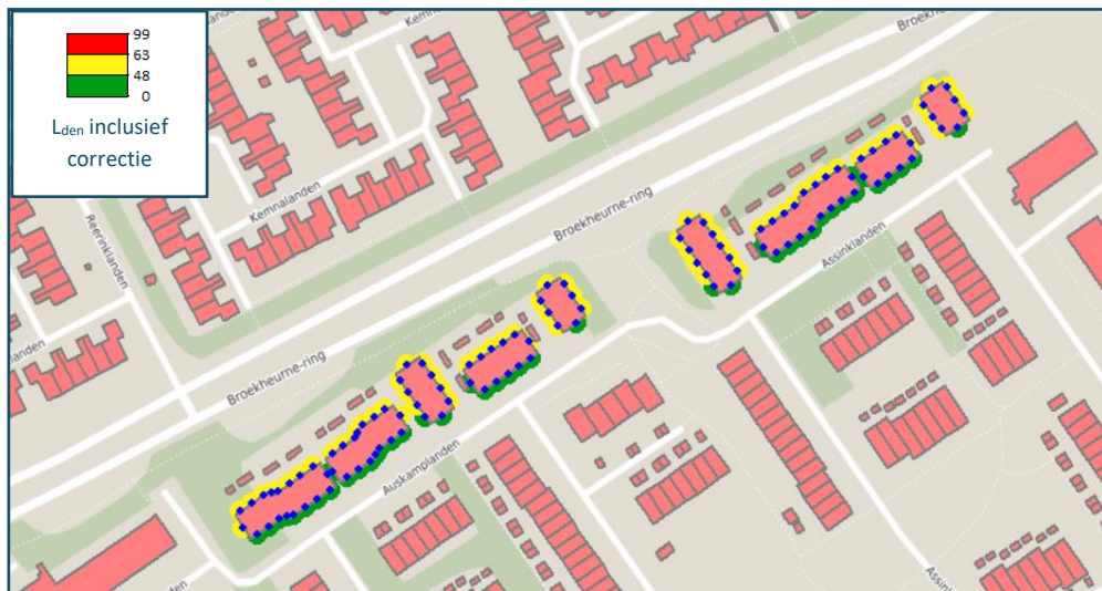
Figuur 4 Weergave van de overschrijdingen vanwege wegverkeer op de Broekheurnering (geel)
