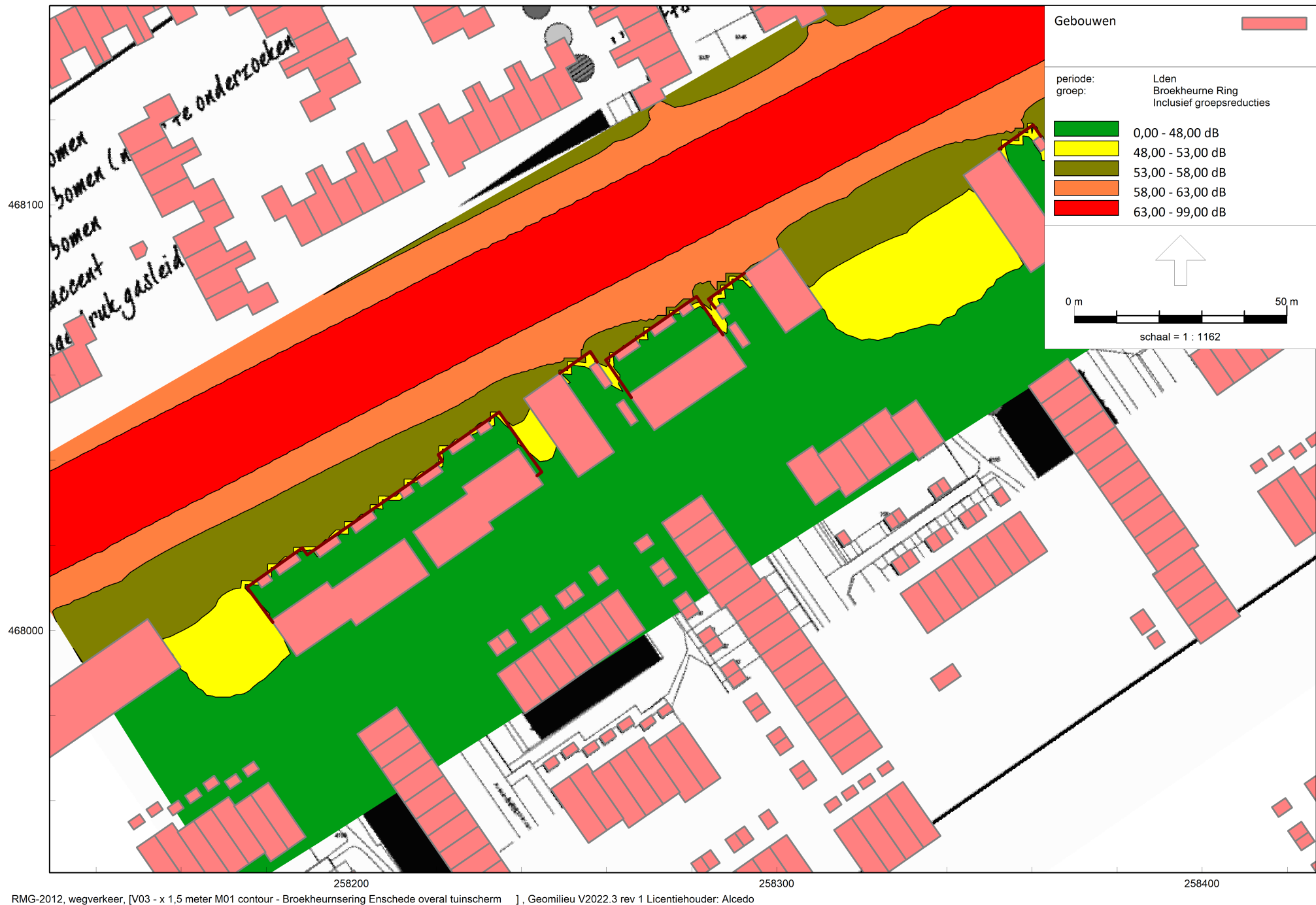
Figuur 12 Contourberekening (1,5 meter beoordelingshoogte) westelijk blok
