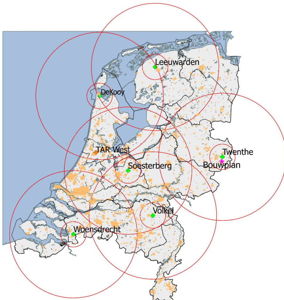
Figuur 2. Locaties van de zes MASS verkeersleidingsradarsystemen (groene ruit) met daaromheen de 15 en 75 km cirkels. De TAR West radar bij Schiphol is aangegeven met een oranje ruit en de infill radar te Wemdinge met een paarse ruit. De oranje vlakken zijn de in de AHN-1 gedefinieerde stedelijke gebieden. De ligging van het te toetsen bouwplan is aangegeven met een roze ster.
