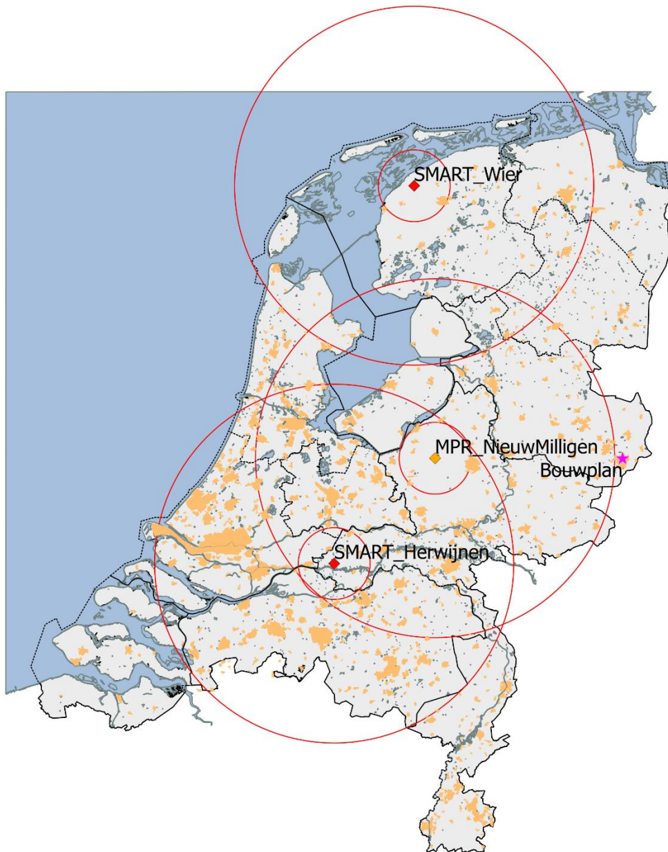
Figuur 3. Locaties van de nieuwe SMART-L EWC GB gevechtsleidingsradars (rode ruit) en de bestaande MPR (oranje ruit) met daaromheen de 15 en 75 km cirkels. De oranje vlakken zijn de in de AHN-1 gedefinieerde stedelijke gebieden. De ligging van het te toetsen bouwplan is aangegeven met een roze ster.
