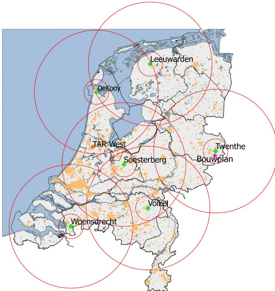
Figuur 2. Locaties van de zes MASS verkeersleidingsradarsystemen (groene ruit) met daaromheen de 15 en 75 km cirkels. De TAR West radar bij Schiphol is aangegeven met een oranje ruit en de infill radar te Wemeldinge met een paarse ruit. De oranje vlakken zijn de in de AHN-1 gedefinieerde stedelijke gebieden. De ligging van het te toetsen bouwplan is aangegeven met een roze ster.
