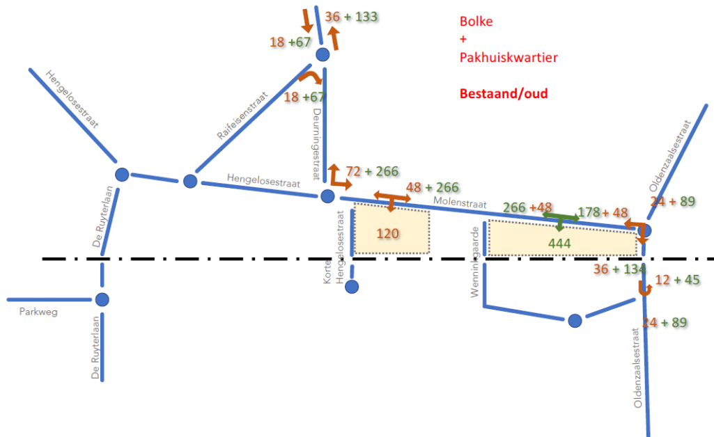
Figuur 6.1 Verkeersgeneratie in motorvoertuigen per etmaal in de referentiesituatie en verwachte rijroutes
