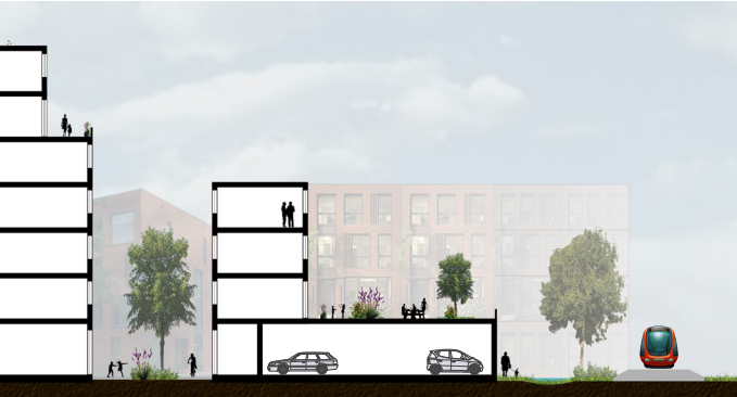
Principe doorsnedes van parkeeroplossing met daa- ren een daktuin
