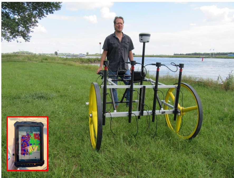
Afbeelding 3.1: Detectievoertuig & handheld (inzet) zoals deze gebruikt is voor het uitvoeren van de computerondersteunde oppervlakedetectie
