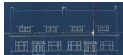
Woningtype A, een 4-onder-1-kap woning A* heeft in het midden een dwarsgeplaatste kap
