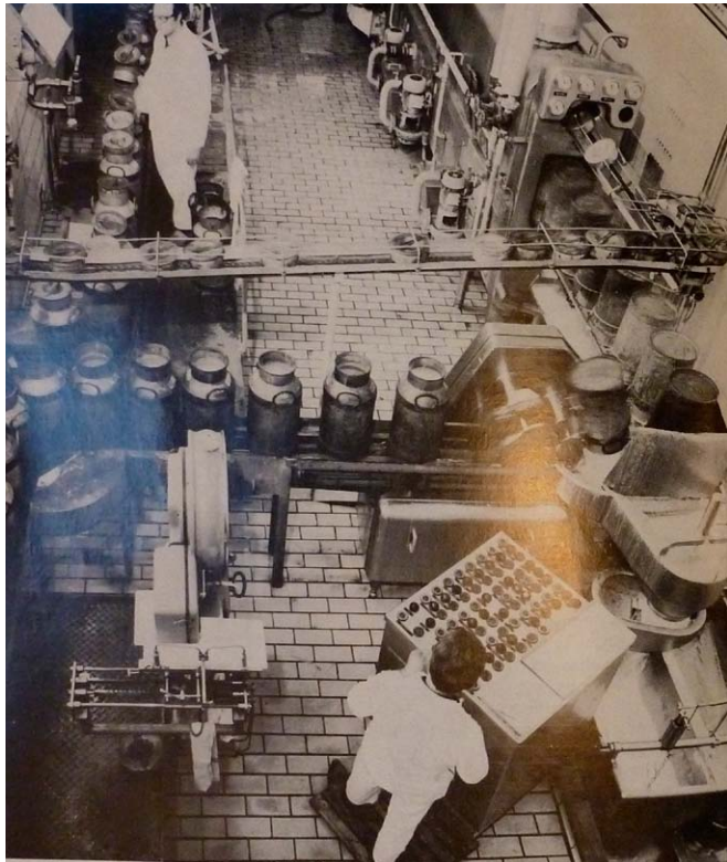
Melkontvangst in het gebouw uit 1956 (nr 4 op de begane grond blz 18). [RAZ]
