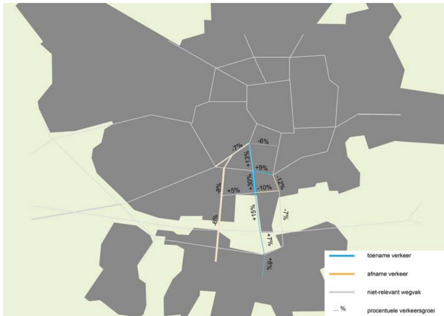
Figuur 4.3: Effecten scenario 1: procentueel verschil met basisscenario uit hoofdstuk 3 (figuur gemeente Enschede)
