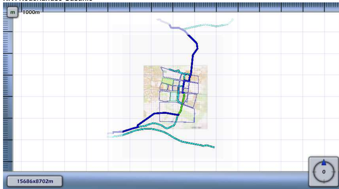
Figuur 4.5 Kilometer leiding behorende bij de maximale overschrijding van de FN-curve voor N-528-57 van N.V. Nederlandse Gasunie
