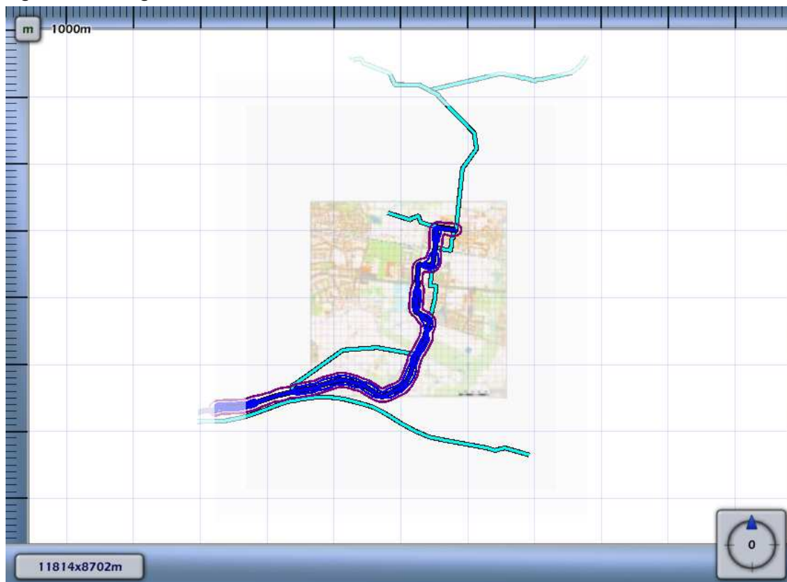
Figuur 3.2 Plaatsgebonden risico voor N-528-50 van N.V. Nederlandse Gasunie
