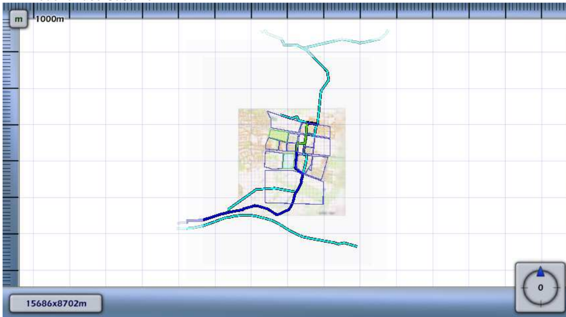
Figuur 4.2 Kilometer leiding behorende bij de maximale overschrijding van de FN-curve voor N-528-50 van N.V. Nederlandse Gasunie
