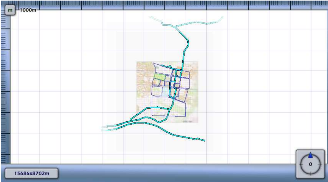
Figuur 4.6 Kilometer leiding behorende bij de maximale overschrijding van de FN-curve voor N-528-80 van N.V. Nederlandse Gasunie
