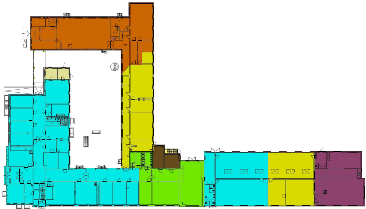
Faseringsplattegrond van de begane grond. Overzicht van de ontwikkelingen na 1912.
