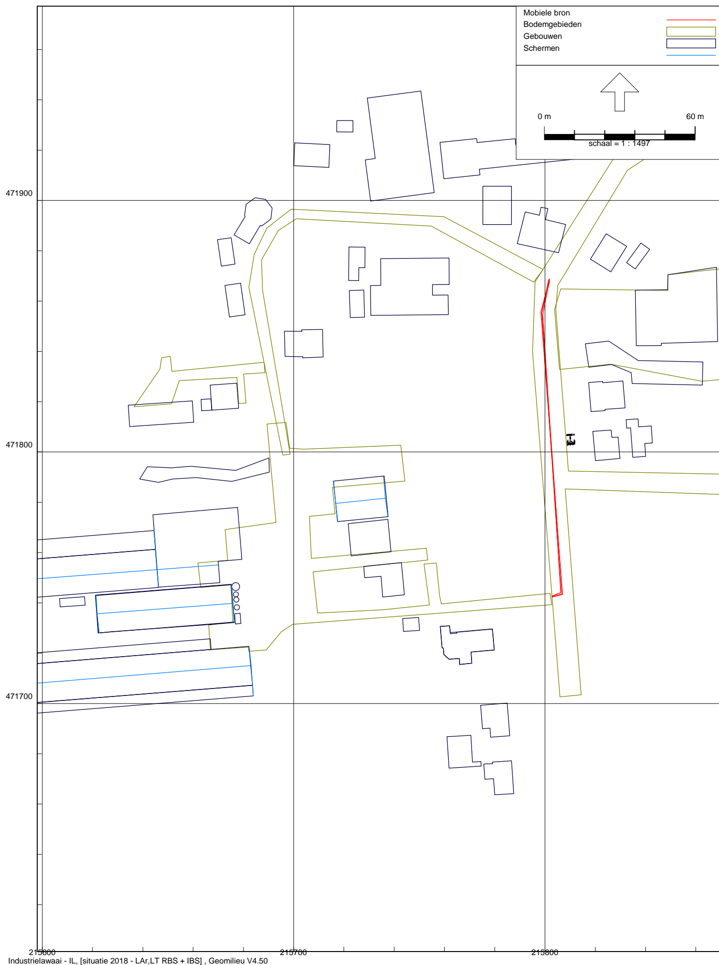
figuur 6: Overzicht rekenmodel met ingevoerde geluidbronnen en gevelbronnen -indirecte hinder-
