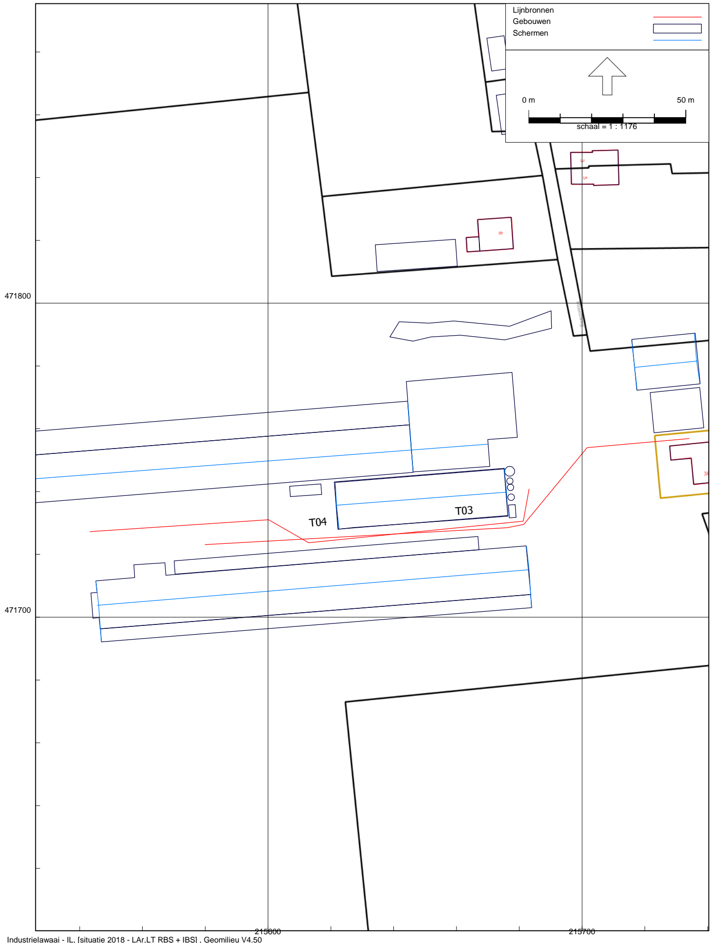
figuur 5c: Overzicht rekenmodel met ingevoerde geluidbronnen en gevelbronnen -RBS-
