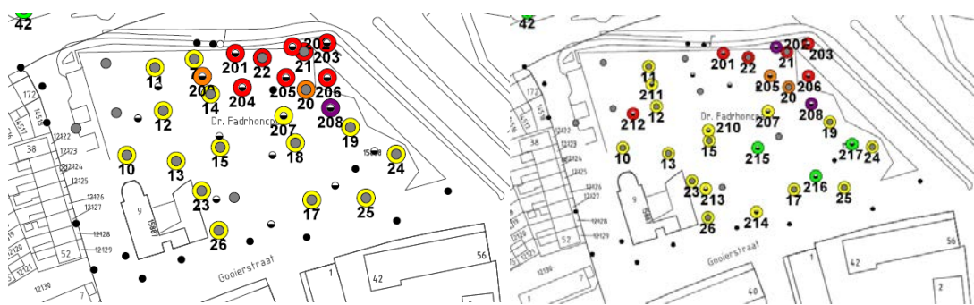
Figuur 2.4 Verontreinigingssituatie van de deklaag op het zuidelijk deel. Links is de kwaliteit van 0-0,4 m -mv gegeven en rechts de kwaliteit van 0,4-1,0 m-mv. Groen < Aw, geel > Aw, oranje > T, rood > I en paars > 10*I
