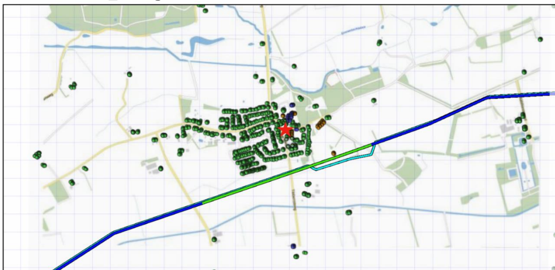
Figuur 4.2 Kilometer leiding behorende bij de maximale overschrijding van de FN-curve voor 6946_leiding-A-510-deel-1 van N.V. Nederlandse Gasunie
