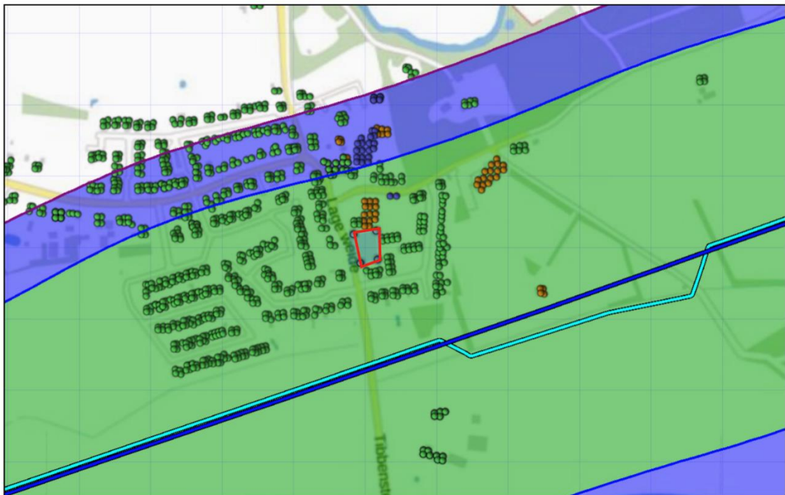
Figuur 3.1 Plaatsgebonden risico voor 6946_leiding-A-510-deel-1 van N.V. Nederlandse Gasunie
