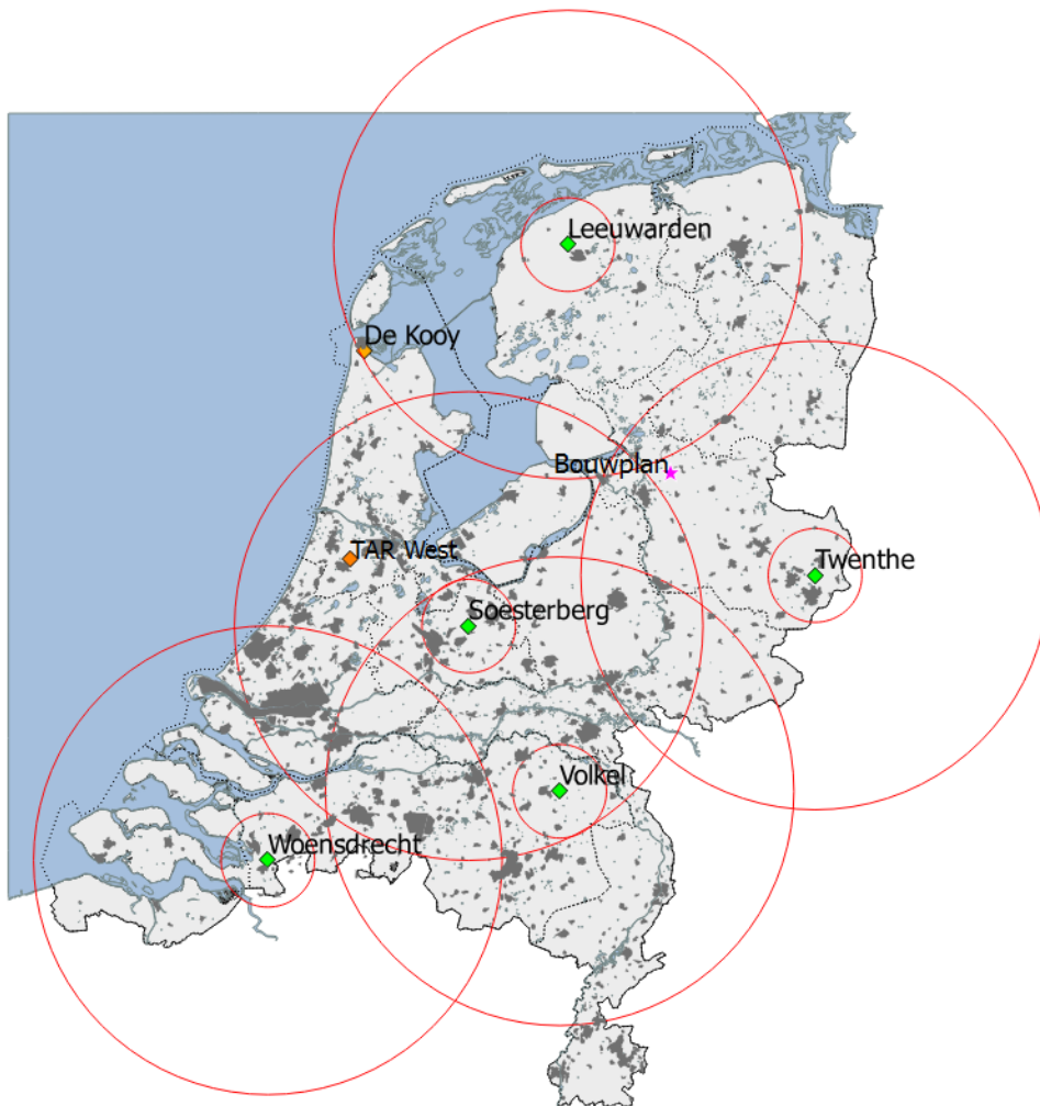
Figuur 2. Locaties van de vijf MASS verkeersleidingsradarsystemen (groene ruit) met daaromheen de 15 en 75 km cirkels. De TAR West radar bij Schiphol is aangegeven met een oranje ruit. De donkergrijze vlakken zijn de in de AHN-1 gedefinieerde stedelijke gebieden. De ligging van het te toetsen bouwplan is aangegeven met een roze ster.
