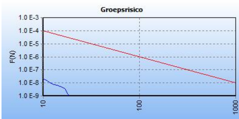
5.1 Figuur 5.1 FN curve voor 3426_leiding-A-510-deel-1 van N.V. Nederlandse Gasunie voor de kilometer tussen stationing 820.00 en stationing 1820.00
