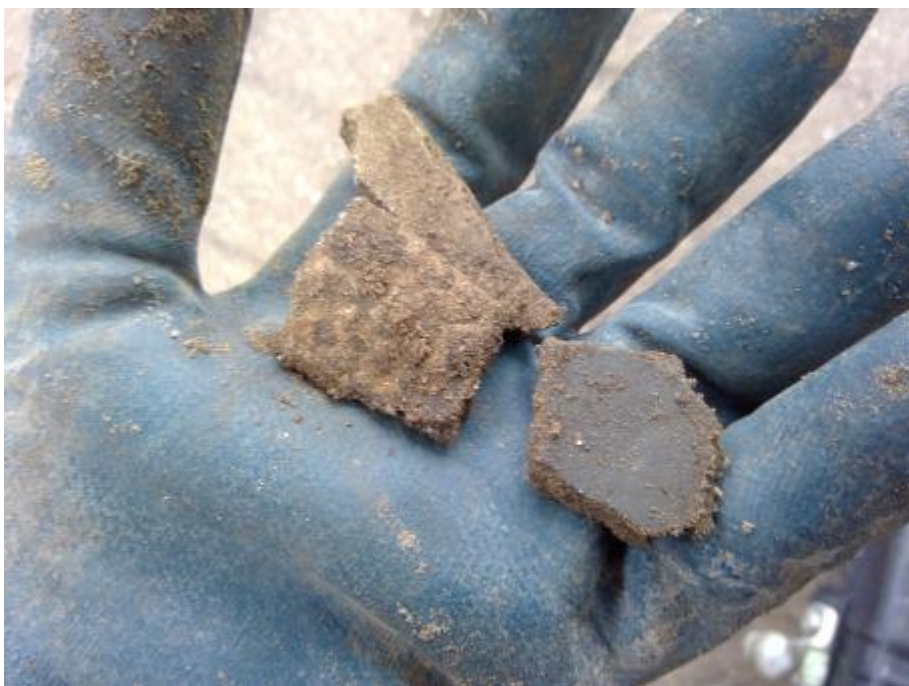
Asbest verdacht materiaal in grond, proefgat A18
