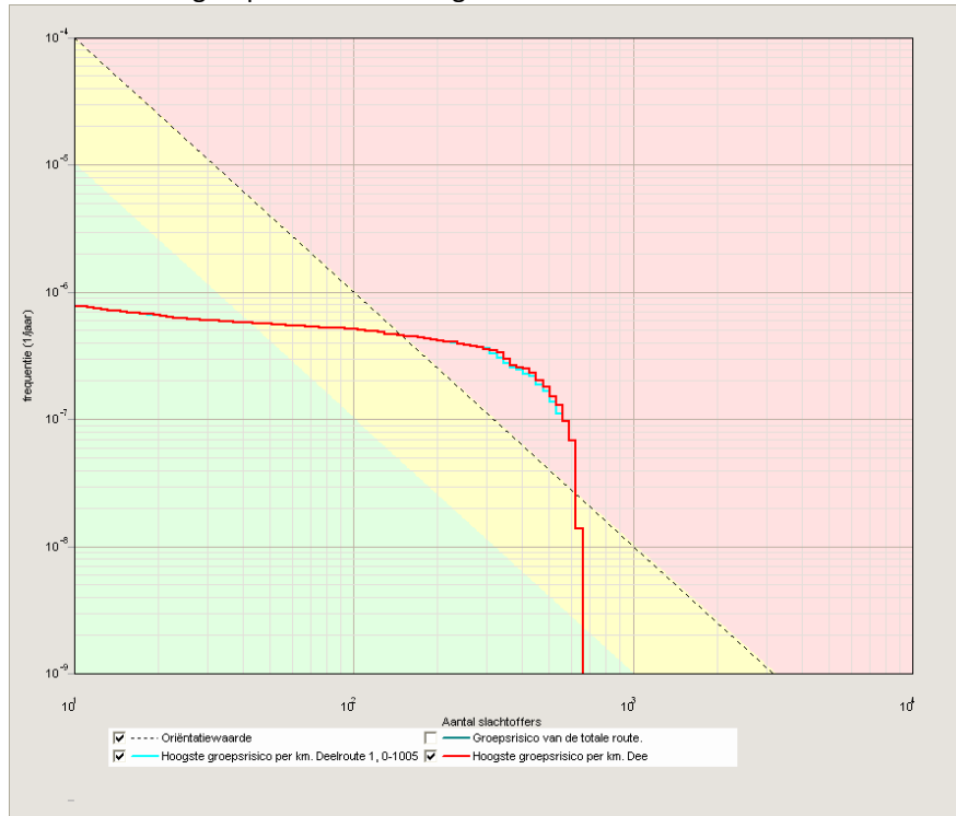
Figuur 4.2 Curven spoorlijn Hengelo - Almelo rood = berekening met plangebied blauw = berekening vigerende situatie
