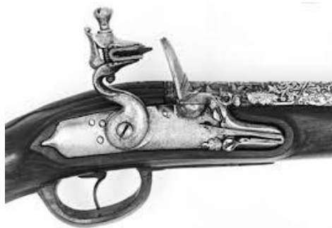
Afbeelding 14; Voorbeeld van een vuursteenslotgeweer met een vuurkets. Bron: www.legemuseum.nl
