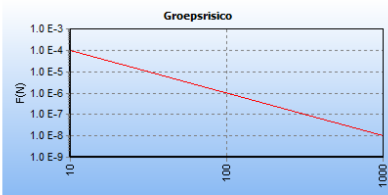
5.1 Figuur 5.1 FN curve voor A-670 van N.V. Nederlandse Gasunie voor de kilometer tussen stationing 3010.00 en stationing 4010.00
